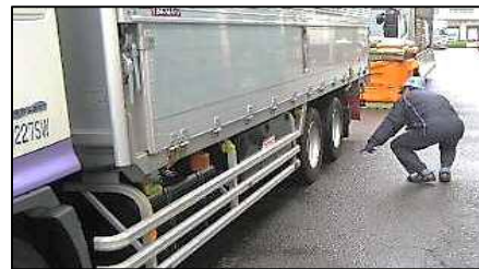
車両下部の油液漏洩が無いか確認
